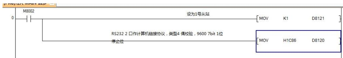
图3.3 计算机链接协议设置
