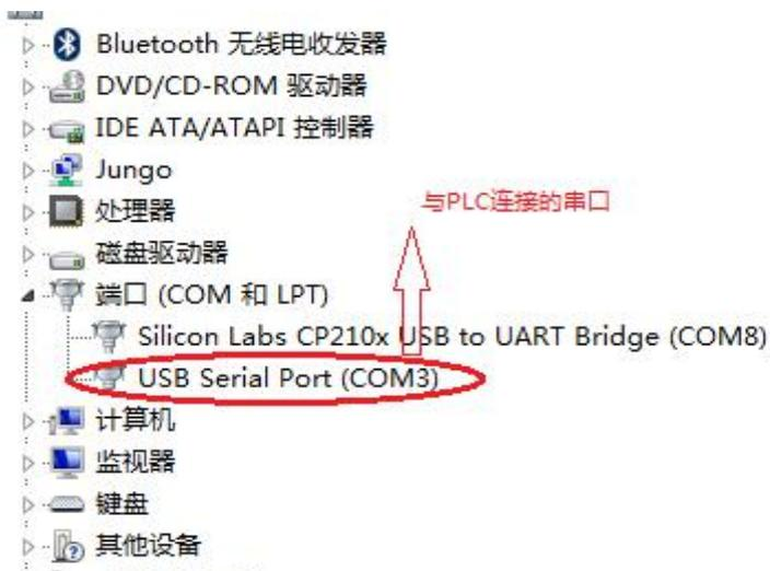
图2.2 与PLC连接的串口
